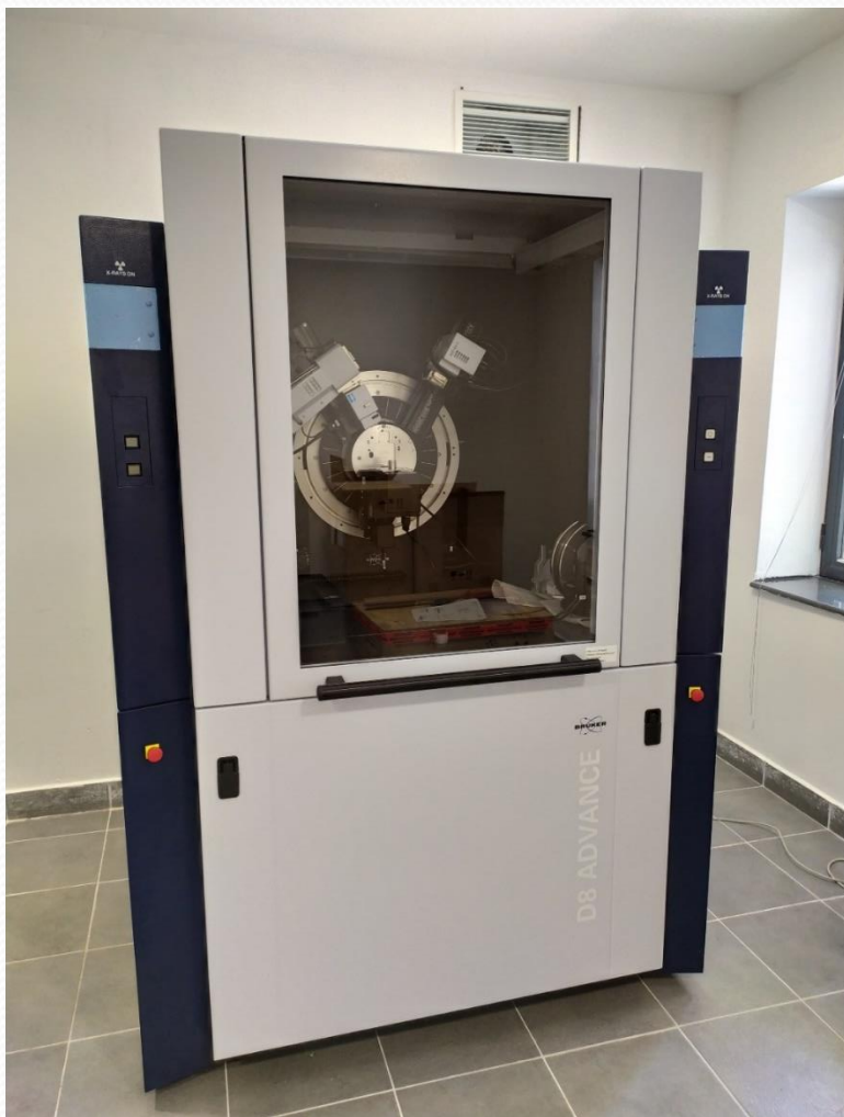
Рентгенов дифрактометър Brucker D8 Advance
